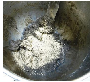
② ミキサー混合 セパットソイル S-30 添加量 30kg/t
