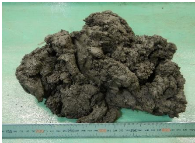
① 軟弱な粘性土（付着性大） 含水比 76.6% コーン指数 60kN/m 2
