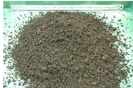
④ 改質土 篩分け容易な状態に変化 突固めコーン指数 425kN/m 2
