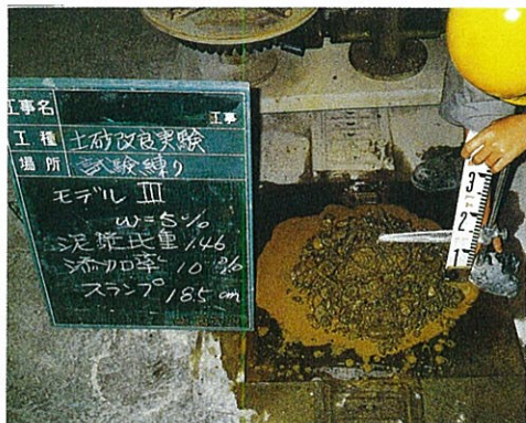
掘削土砂 (分離)
