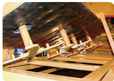
特許の高速ミキサー 可変速160~320rpm
